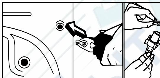
**ОСТОРОЖНО:** Фильтры подачи воды могут засориться из-за загрязнения водопроводной воды или отсутствия необходимого технического обслуживания, или возможна поломка клапанов, в результате чего вода будет постоянно протекать внутрь машины. Поломки, которые могут возникнуть по этой причине не подпадают под действие гарантии.
