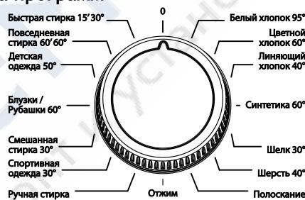
С помощью Ручки выбора программы Вы можете выбрать нужную программу стирки путем поворота ручки в обоих направлениях. Обратите внимание на то, что значок, обозначающий выбранную программу, точно обозначает положение, в которое нужно установить ручку. Если Вы повернете Ручку выбора программы в положение "0" во время выполнения программы, стирка останется не завершенной.
